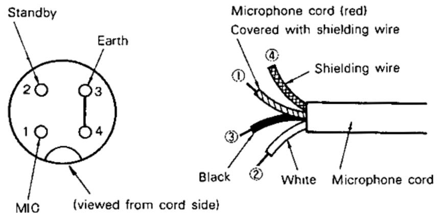
**FIG. 24 CONNECTION OF MICROPHONE CONNECTOR**
