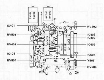
IC103 AF AMP IC IC401 REGULATOR POWER IC IC402 POWER SWITCH IC IC403 POWER SWITCH IC IC405 FM MIC AMP IC IC504 TONE IC TONE CREAMIC OSC Y505 **RV401** FM DEV ADJ **RV202** TX METER ADJ RV501 FM FREQ ADJ **RV504** TONE DEV ADJ **RV505** TONE TIME ADJ
